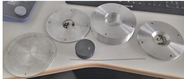
Abbildung 21: Aluminium-Körper mit Grafit-Probe (Quelle: [Fun21a] S. 3)
