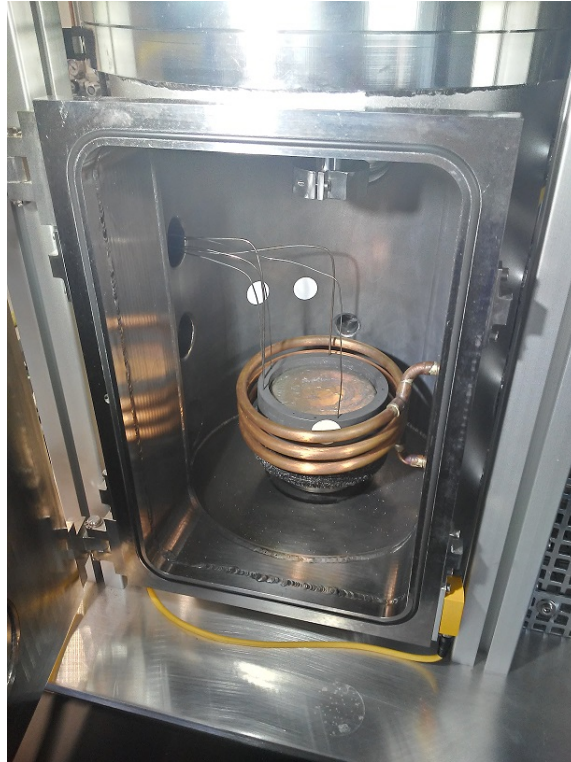
Abbildung 3: Anlage mit Grafit-Tiegel (Suszeptor) (Quelle: eigene Darstellung)
