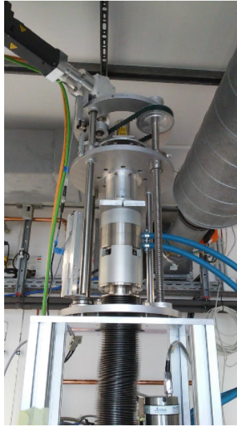
Abbildung 51: Antrieb der Spindel (Welle) (Quelle: eigene Darstellung)
