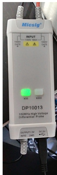
a) Spannungsmessung mit Differentialtastkopf - DP10013 von Micsig
