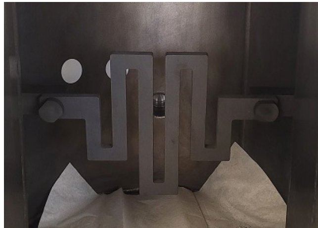
Abbildung 2: Grafit-Heizer (mäanderförmig) (Quelle: eigene Darstellung)
