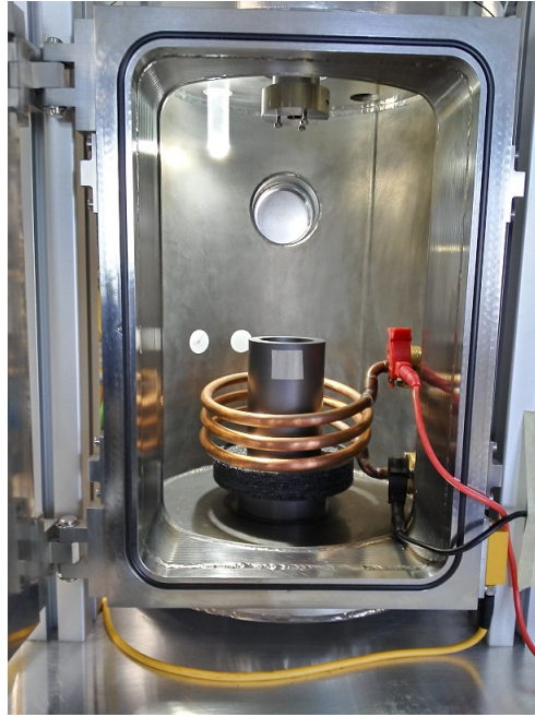
Abbildung 69: Test Graft-Block in Test-CZ Spule (Quelle: eigene Darstellung)
