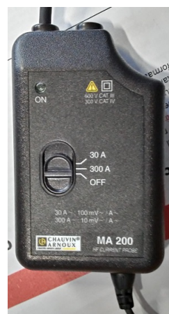
b) Strommessung mit einer Rogowskispule von Typ MA 200
