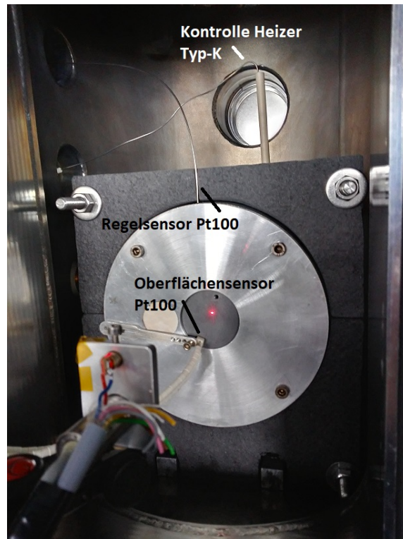
Abbildung 26: Genutzte Sensoren im/am Aluminium-Körper (Quelle: eigene Darstellung)
