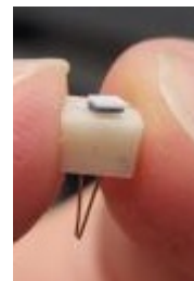
b) Aussehen des Pt100-Sensors
