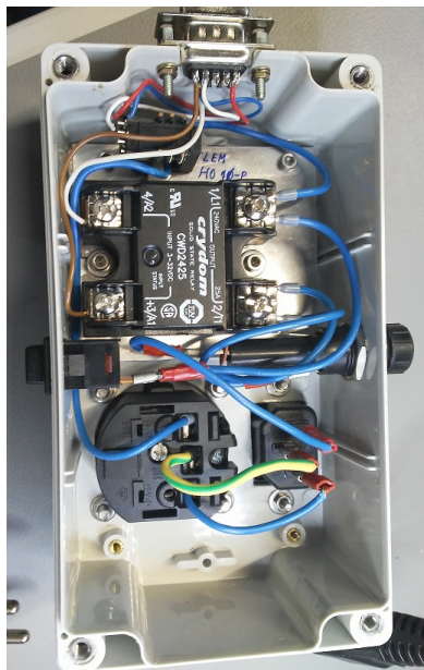
a) Solid-State-Relais innen (Quelle: eigene Darstellung)
