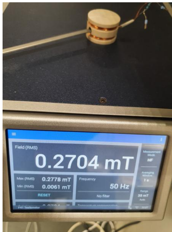
Abbildung 45: Kontrolle des Magnetfeldes der Helmholtzspule (Quelle: eigene Darstellung)
