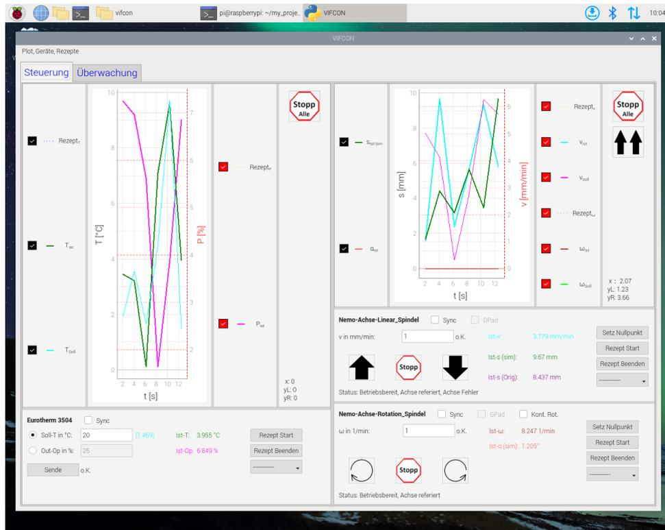
Abbildung 65: Aussehen der GUI von VIFCON auf Raspberry Pi (Quelle: eigene Darstellung)
