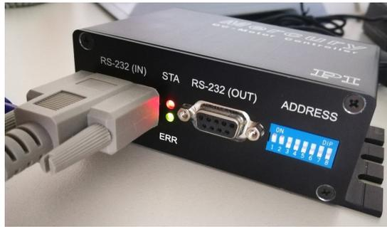
Abbildung 23: Mercury-DC-Controller - Schalterfläche (Modell C-862) (Quelle: eigene Darstellung)
