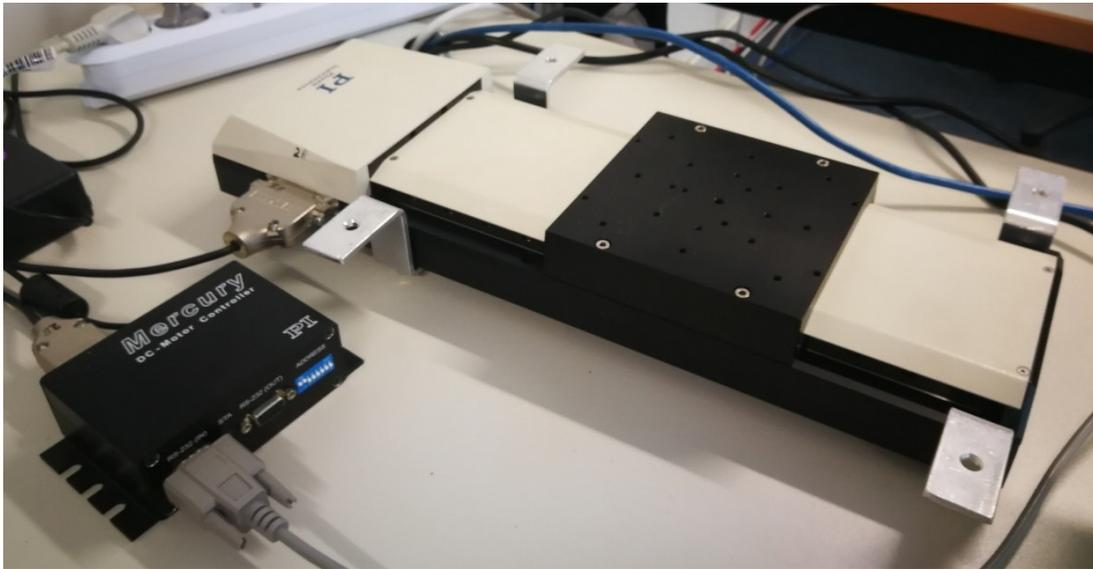
Abbildung 20: PI-Achse mit Mercury-DC-Controller des Modells C-862 (Quelle: eigene Darstellung)
