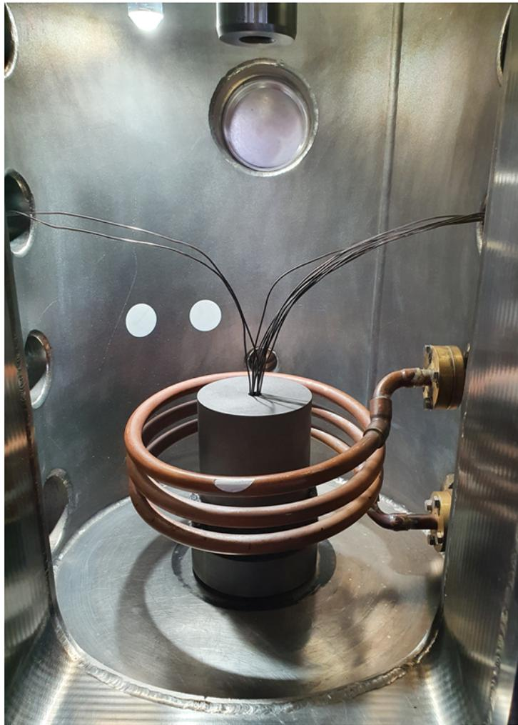
Abbildung 72: Aufbau im Züchtungssofen (Quelle: [Perc])
